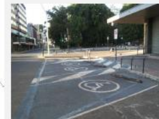
Foto 33: Estacionamientos para PcD en diagonal y conectados a la vereda
