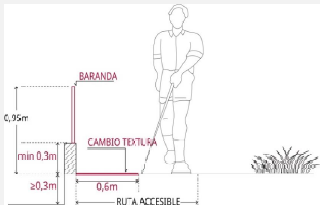
Fig 3 y 4: Protección en el costado de una ruta accesible al existir cambios de nivel superiores a 0,30 m.
